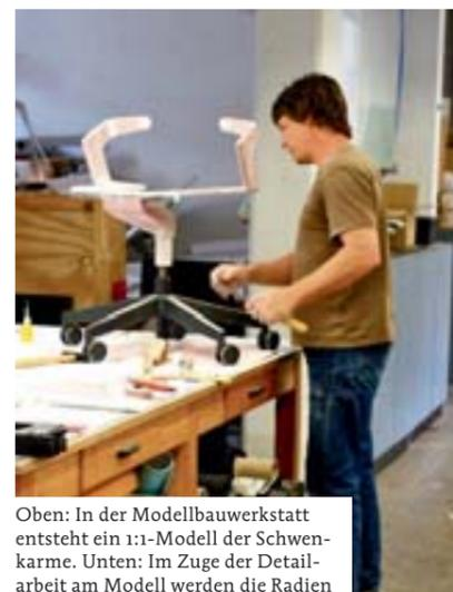
Oben: In der Modellbauwerkstatt entsteht ein 1:1-Modell der Schwenkarme. Unten: Im Zuge der Detailarbeit am Modell werden die Radien optimiert. | Above: A 1:1 model of the swivel arm under construction in the model workshop. Below: Detail work includes optimising the radius.
